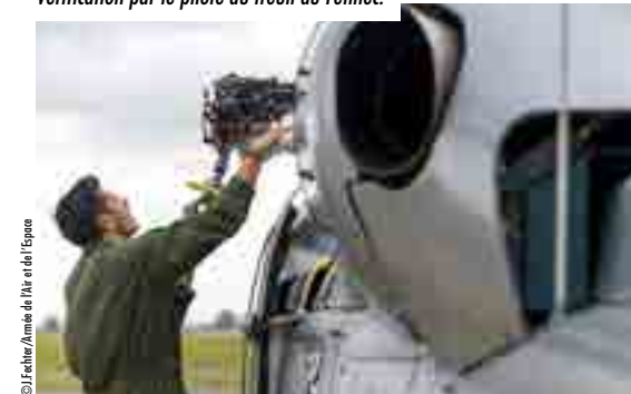
Vérification par le pilote du treuil du Fennec.
