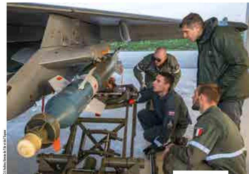
Des mécaniciens de piste croates montent une bombe GBU-12 d'entraînement sur un Rafale B.
