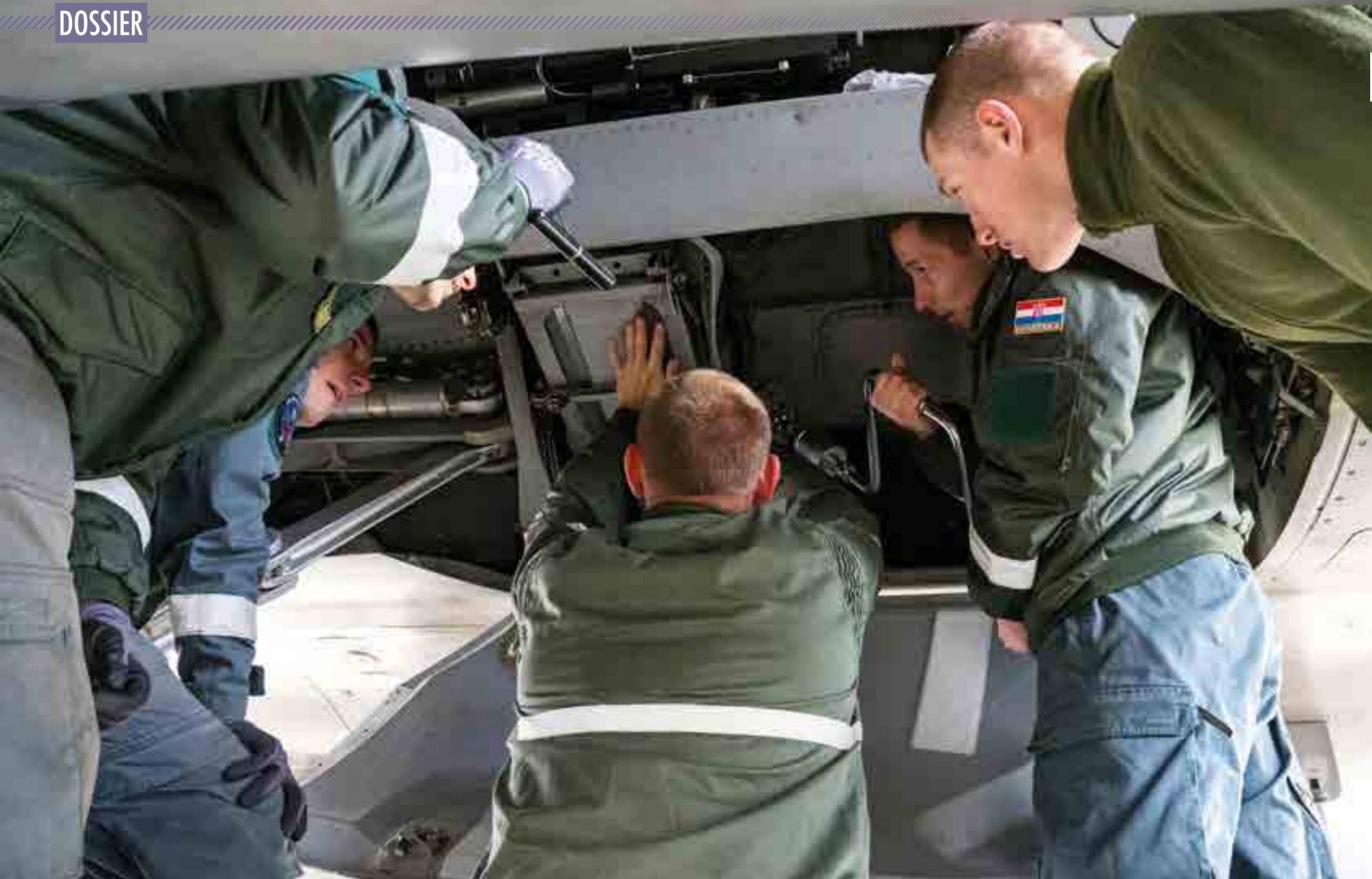
Travail avec nos alliés. Des mécaniciens armement croates montent le chariot d'obus sur un Rafale.
