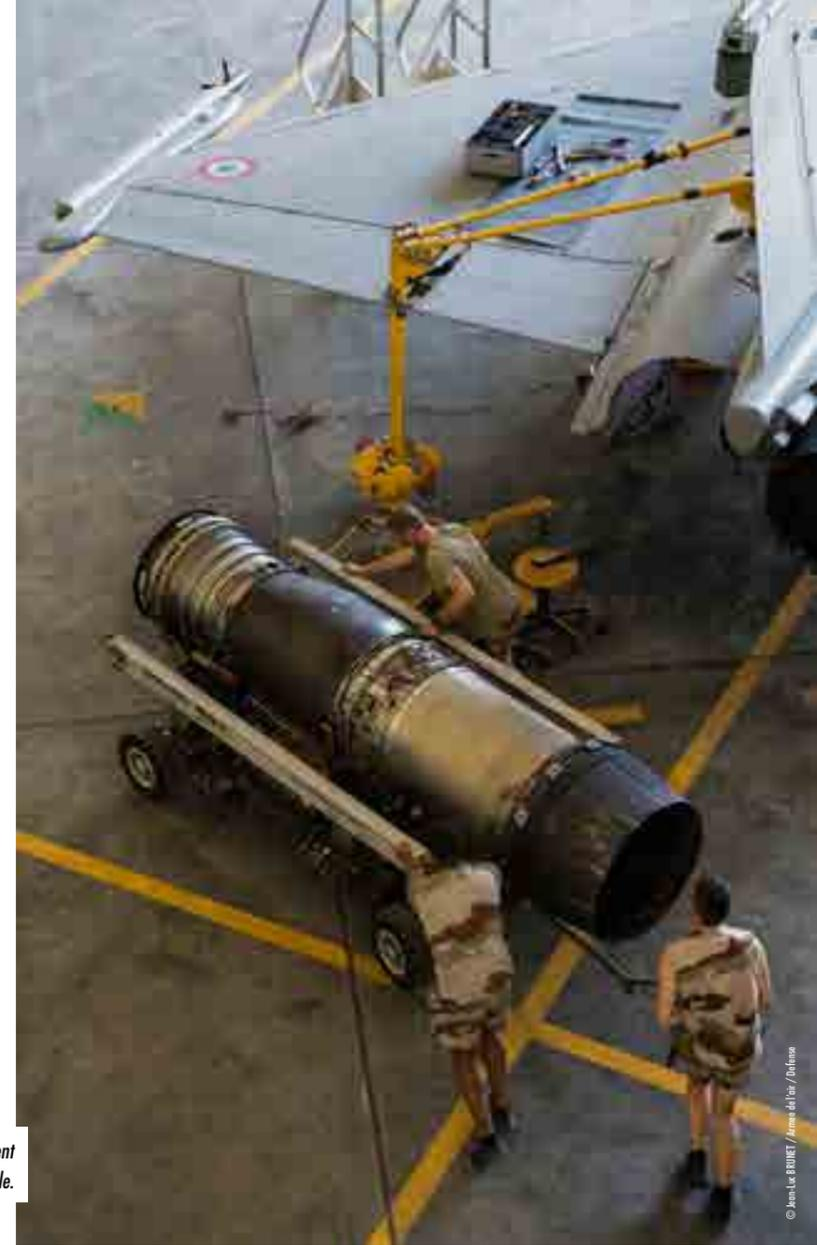
Des mécaniciens motoristes déposent un réacteur M88 d'un Rafale.
